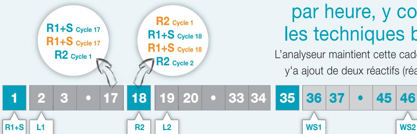
Séquence du cycle machine du BA200: R1 et l'échantillon sont déposés tous les deux pendant le cycle 1, pas bescin de temps additionnel pour la pré-thermostatisation de R1.
